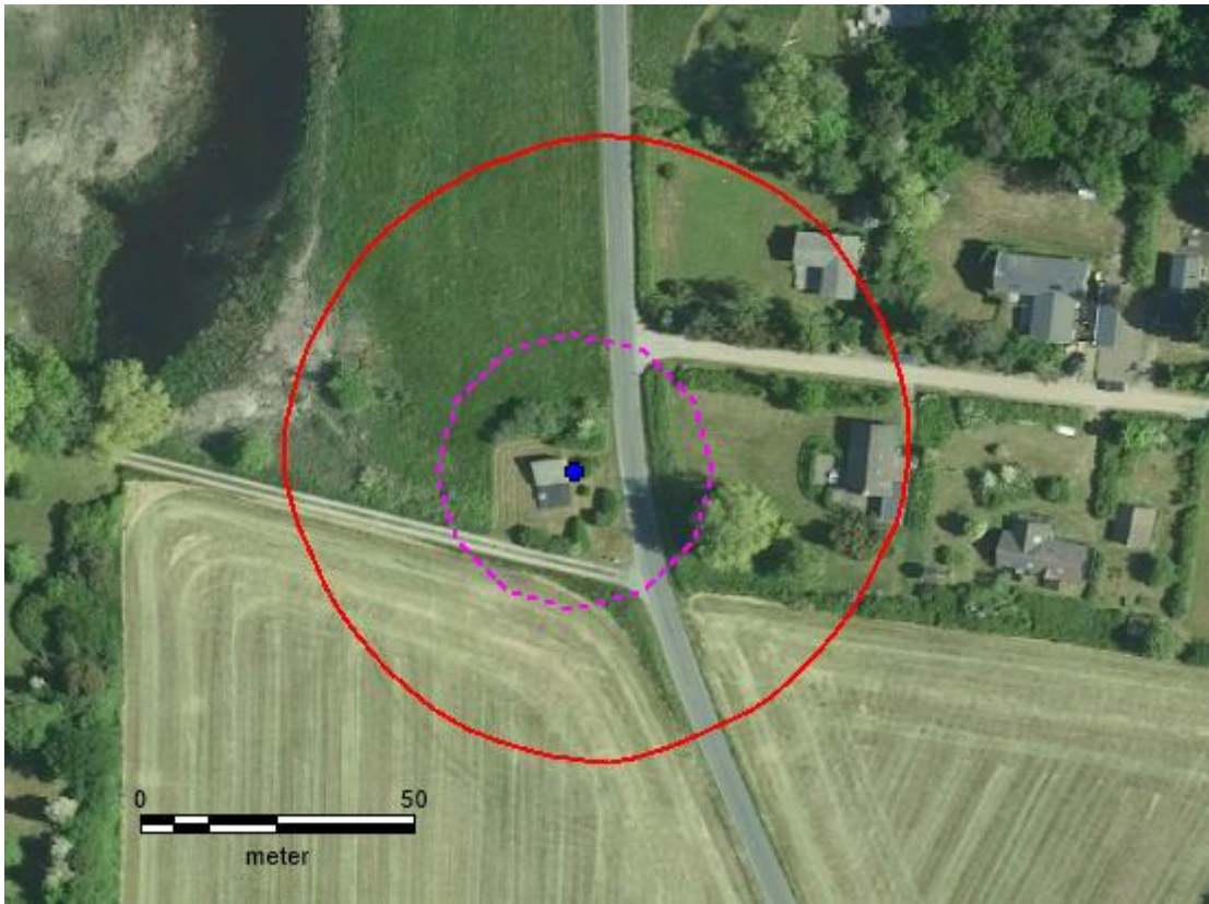
Figur 7.2. BNBO ved Bogensø. Stiplet lilla cirkel er 25 m zone. Rød er BNBO.
